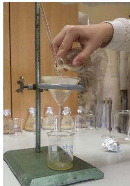
Fotografija 4: Postopek filtriranja (lasten vir)
