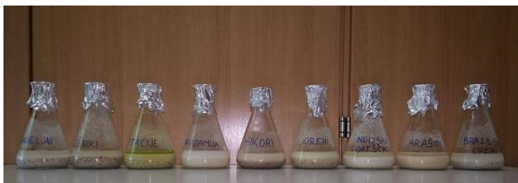
Fotografija 3: Mleti oreščki, preliti z acetonom (lasten vir)
